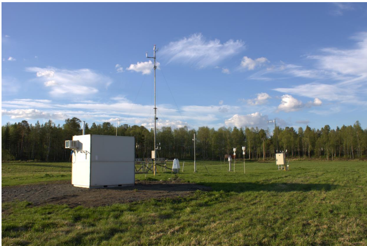
Figur 5: NILUs målestasjon på Svanvik. Den ligger ute på jordet ved Svanhovd miljøsentor (NIBIO). Merk inntak for støvmålinger på taket til venstre og inntak for SO 2 -målinger på taket til høyre (svanehals). Masten har meteorologiinstrumenter i 10 m høyde. To nedbørprøvetakere til høyre tar prøver for tungmetaller. Instrumentet helt til høyre tilhører NVE. Stativet med metallplater i bakgrunnen er en del av et europeisk korrosjonsprosjekt (Grøntoft og Ferm, 2014). Strålevernets instrumenter er skjult bak måleboden.
