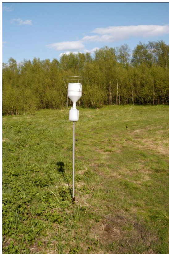
Figur 20: Nedbørsamleren i Karpbukt. Plasttrakt fanger nedbøren som samles i en plastflaske. Legg også merke til ringen øverst. Den er plassert slik for at fugler skal sette seg på ringen framfor kanten av samleren. Dette for å unngå fugleskit i prøven.
