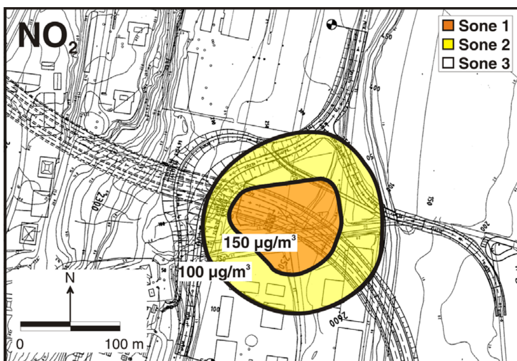
Figur 2: Belastning av \text{NO}_2 ved østre tunnelmunning. Isolinjer for timemiddelkonsentrasjoner.
