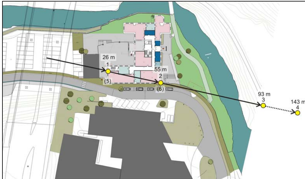
Figur 1: Reseptorpunkter benyttet ved spredningsberegninger i området Nydalen i Oslo. Reseptorpunkter 1-6 med avstander i meter til midtdeler på Nydalsbrua. Reseptorpunkter 1 og 2 er 12 m over bakken, mens øvrige reseptorpunkter er i bakkenivå.
